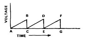
B. SAWTOOTH WAVEFORM PLOTTED AGAINST TIME
